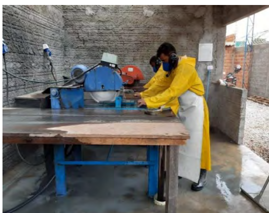
Figura 6.3.3: Serras de corte dos testemunhos de sondagem e galpão de estocagem, em Tucumã/PA. Fonte: Centaurus (2022).
