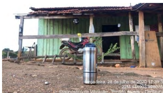
Figura 10.1.30 - Detalhe do posicionamento em campo dos equipamentos e da medição de vibração no ponto P1.
