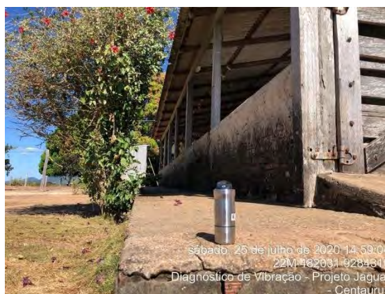
Figura 10.1.31 - Aspecto do posicionamento em campo dos equipamentos de medição de vibração no ponto P3. Fonte: Q3A (2020b) apud Bicho do Mato (2021).
