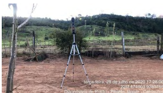
Figura 10.1.25 - Detalhe do posicionamento dos equipamentos para a realização da aferição de ruídos no ponto P1
