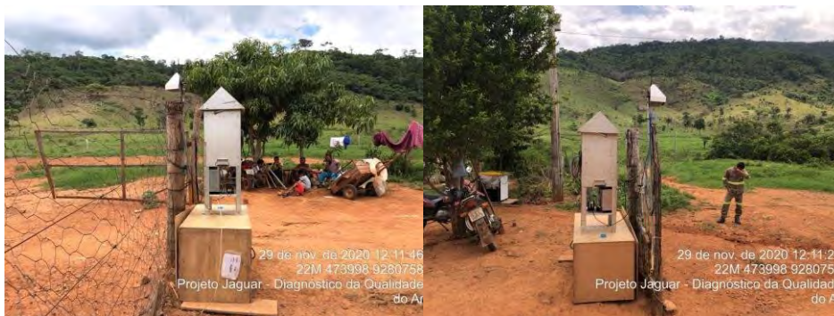
Figura 10.1.14 - Detalhe dos equipamentos de medição de qualidade do ar no ponto P1 Fonte: Q3A (2020) apud Bicho do Mato (2021).
