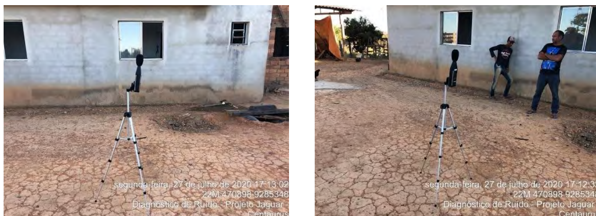
Figura 10.1.27 - Detalhe do posicionamento dos equipamentos para a aferição de ruídos no ponto P4.
