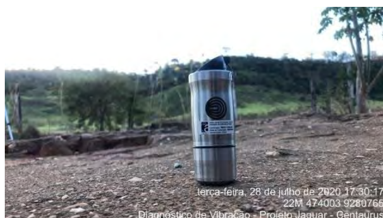
Figura 10.1.30 - Detalhe do posicionamento em campo dos equipamentos e da medição de vibração no ponto P1.
