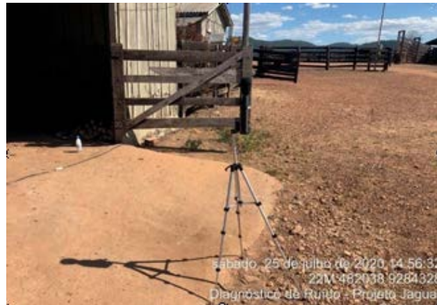
Ponto P3, ilustrando o posicionamento dos equipamentos para a medição de ruído. Fonte: Centaurus, 2023.
