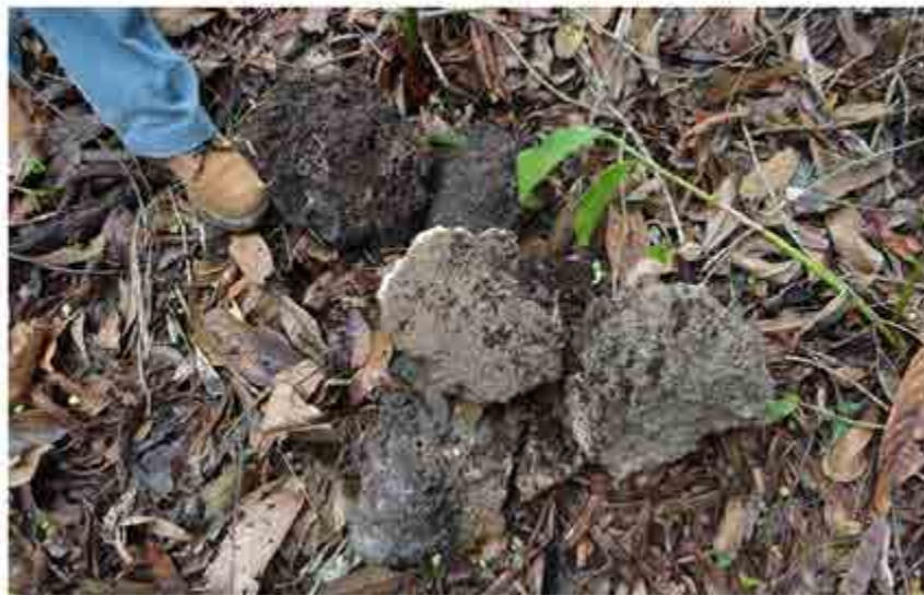
Figura 250 Escórias de ferro encontradas no local indicam que ali se fundia o minério de ferro
